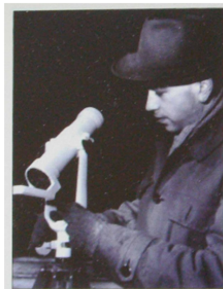
Szovjet AT-1-es optikai műhold-követésre, -megfigyelésre való távcső az 1960-as évekből. A műszer mellett Almár Iván látható
